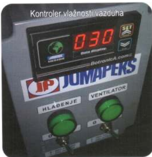
Unutrašnjost mobilnog rashlađivača Kapacitet ventilatora 12.500 m 3 /h, snaga 0,5 kw
